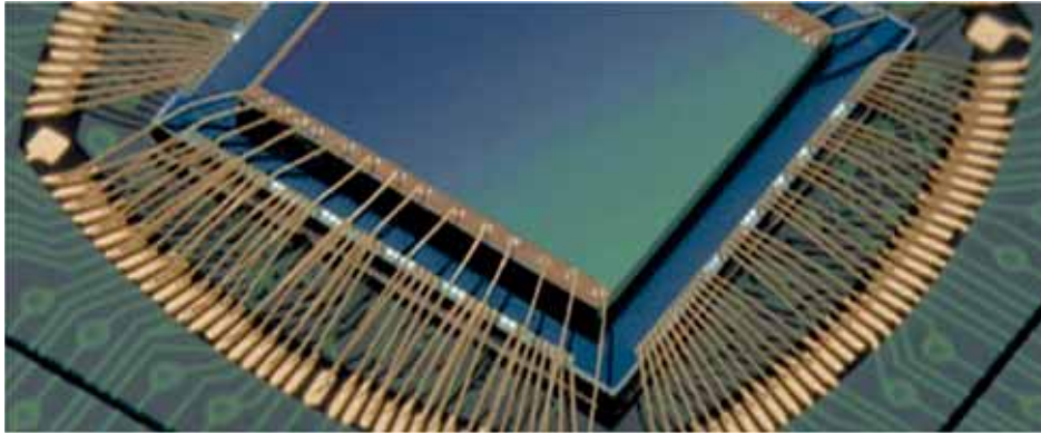
Figura 3 – Fios de ouro soldados no die de memória
