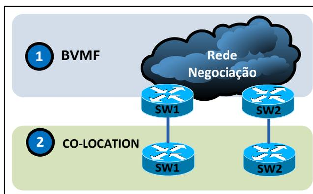
Por definição, o modo de acesso Lan Co-location dispõe de uma única forma de acesso, na qual são providos 2 (dois) pares de fibra óptica multimodo com velocidade de 10Gbps. Cada par de fibras é conectado a um equipamento distinto dentro da infraestrutura do Data Center B3, provendo, dessa forma, alta disponibilidade em relação aos meios físicos e equipamentos de rede.
