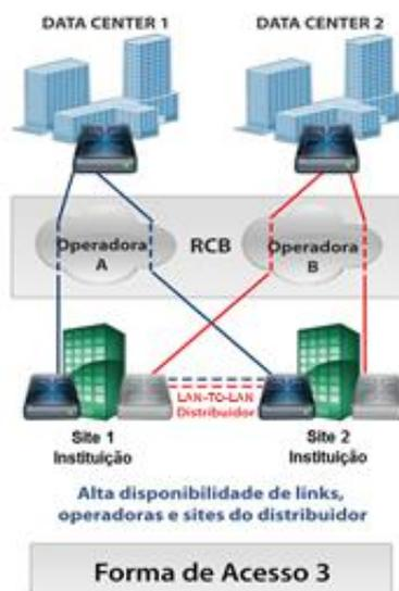
Nessa configuração, são instalados dois links por site da instituição – um conectando ao Data Center 1 e outro conectando ao Data Center 2 –, devendo os links de um mesmo site ser providos por operadoras distintas. Essa é a configuração mais completa, pois, além da contingência de acesso à infraestrutura tecnológica da B3 e ao backbone da operadora, permite que a instituição, na total indisponibilidade de um de seus dois sites, opere pelo site ativo adjacente.
