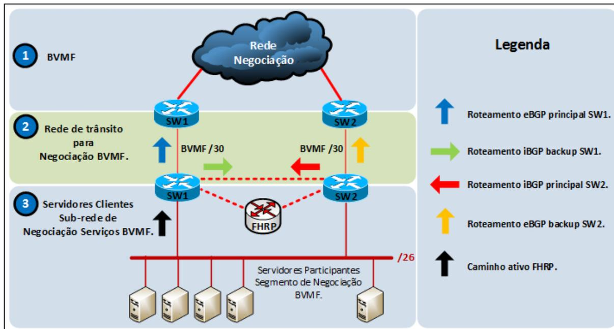
Do ponto de vista lógico, as duas conexões à rede de trânsito para negociação são ponto a ponto com padrões de endereçamentos IPs fornecidos pela B3 e máscara de rede 30. Nesse perímetro, é premissa a configuração do protocolo BGP para comunicação do ambiente de instituição com a rede de negociação da B3.
