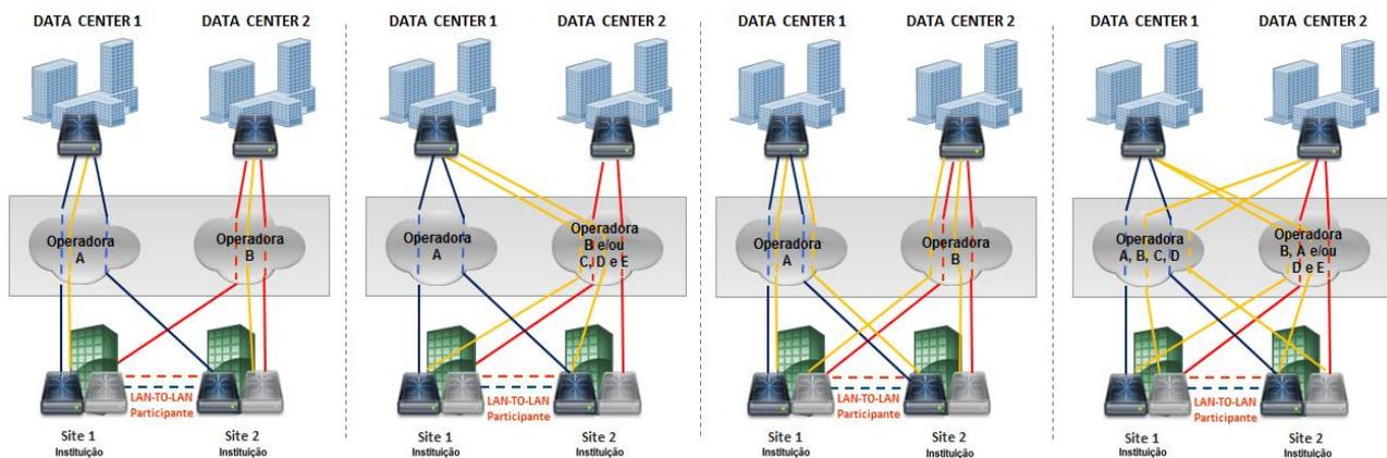
Visto que essa modalidade visa a permitir a contingência de link para a instituição em um mesmo CPE com seu respectivo Data Center da B3, é importante destacar que, além da necessidade de que o dimensionamento de banda para os links adicionais sejam iguais ao link primário e conectados ao mesmo CPE, não é possível a segmentação de tipos de tráfego, serviços ou balanceamento de carga entre links primários e secundários.
