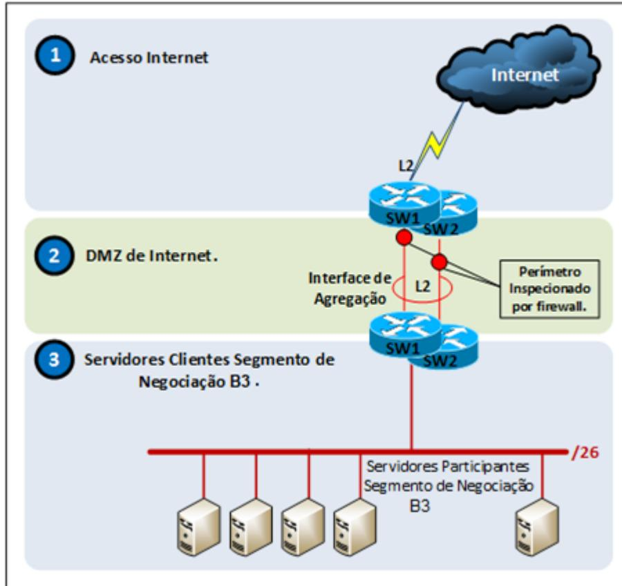
Do ponto de vista lógico, o switch que recebe a conexão do link internet do participante terá uma configuração em camada 2, que passará por um firewall e levará esse acesso ao rack de negociação do participante. Nesse perímetro, as portas de comunicação de entrada e saída para internet serão restritas.
