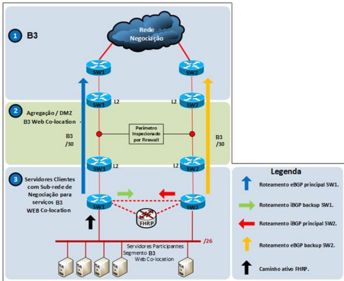
Do ponto de vista lógico, as duas conexões à rede de trânsito para negociação são ponto a ponto com padrões de endereçamentos IPs fornecidos pela B3 e máscara de rede /30. Nesse perímetro, é premissa a configuração do protocolo BGP para comunicação do ambiente de instituição com a rede de negociação da B3.
