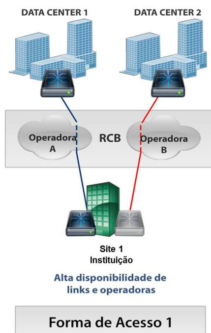
Nessa forma de acesso, são utilizados dois links com dois roteadores na instituição: um link instalado no Data Center 1 e outro no Data Center 2 da B3, por meio de quaisquer duas operadoras distintas dentre as constantes do item 3.4 deste manual. O fornecimento dos CPEs instalados na instituição é de responsabilidade desta, que poderá adquiri-los ou locá-los de algum parceiro ou de uma das operadoras indicadas pela B3.
