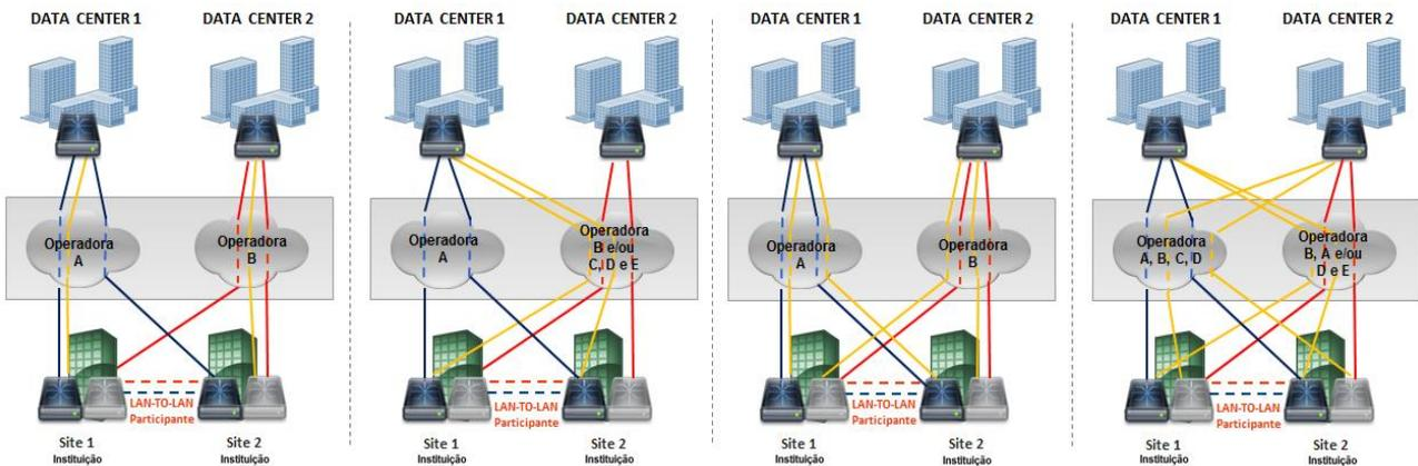
Visto que essa modalidade visa a permitir a contingência de link para a instituição em um mesmo CPE com seu respectivo Data Center da B3, é importante destacar que, além da necessidade de que o dimensionamento de banda para os links adicionais seja igual ao do link primário e que tais links estejam conectados ao mesmo CPE, não é possível a segmentação de tipos de tráfego, serviços ou balanceamento de carga entre links primários e secundários.
