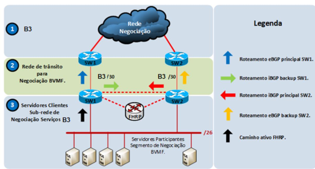
Cada cabo é conectado a um equipamento distinto dentro da infraestrutura do Data Center B3, provendo, dessa forma, alta disponibilidade em relação aos meios físicos e equipamentos de rede.
