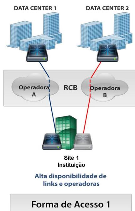
Nessa forma de acesso, são utilizados dois links com dois roteadores na instituição: um link instalado no Data Center 1 e outro no Data Center 2 da B3, por meio de quaisquer duas operadoras distintas dentre as constantes do item 3.7
