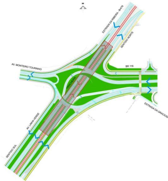
Figura 32 – Transposição em desnível no entroncamento da Av. Linha Verde com a rodovia BR-116
