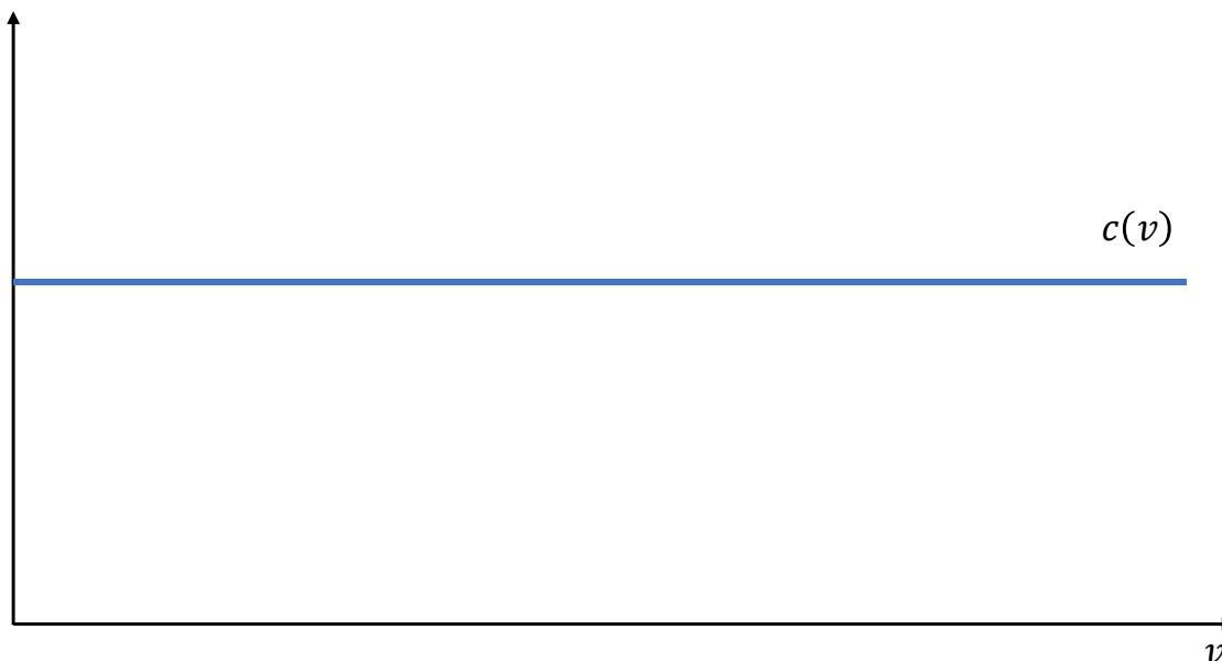
A curva  $c(v)$ , com estrutura *flat* (1), possui um valor constante para todos os vértices,  $v$ , na data  $t$ . Este valor pode ser fixo ou variável para cada data  $t$ . Sua estrutura é dada por:
